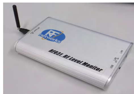
図2 高速スキャン電波モニタ装置(RF-031)
