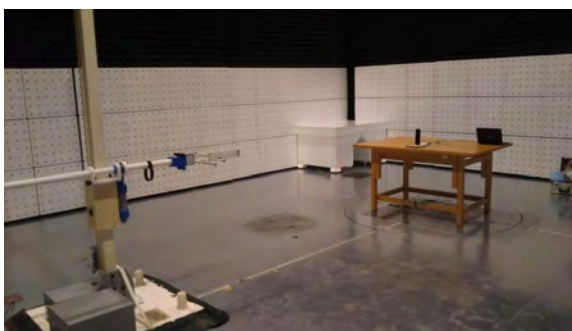
図1 電波暗室での疑似評価環境
