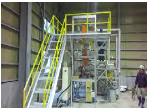
図2 連続式の過熱水蒸気炭化炉
