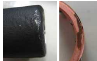
図1 めっき製品の腐食・変色の例
