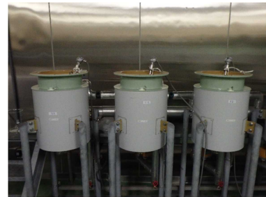
図1 総米6kgの清酒醸造試験の様子
