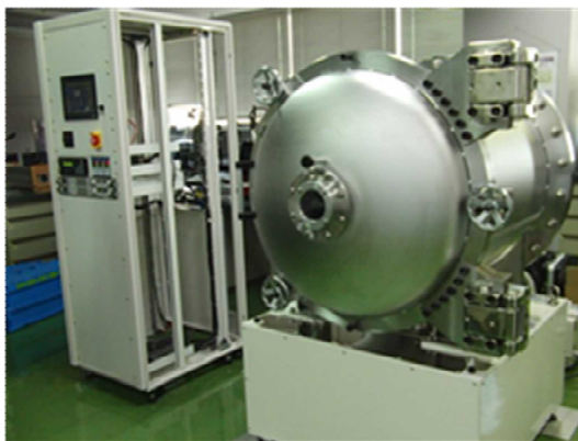
図1 新型プラズマ照射装置実証装置 (左：制御系 右：照射用チャンバー)
