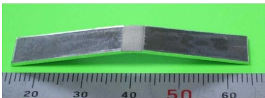
図1 純アルミ (板厚1mm) の曲げ加工例
