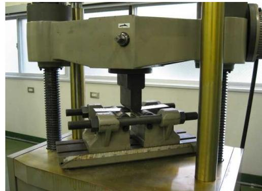
図2 3点曲げ試験
