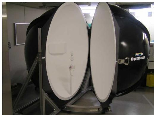
図 1 全光束測定システムの積分球
