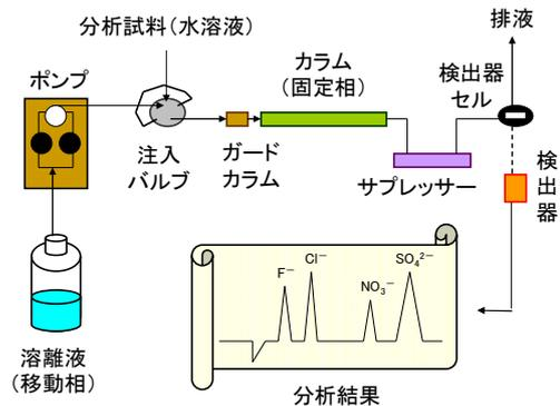
図 2 イオンクロマトグラフの装置構成
