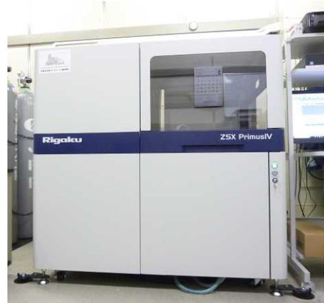
図1 波長分散型蛍光 X 線分析装置
