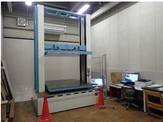
図1 箱型圧縮試験機
