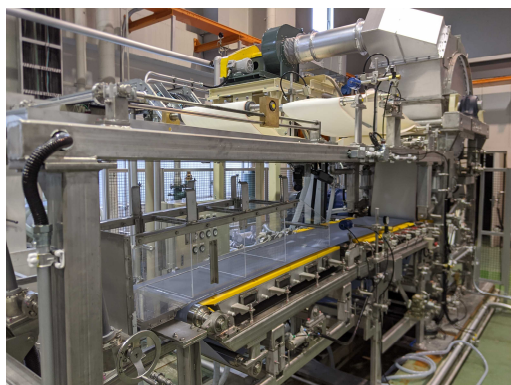
写真1 高機能シート試作装置 （ワイヤー側から）
