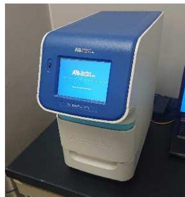
図 2 リアルタイム PCR 装置外観
