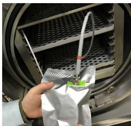
写真2 センサーを差し込んだ状態のサンプル
