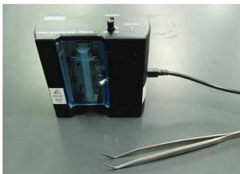
写真 1 可搬型接触角計
