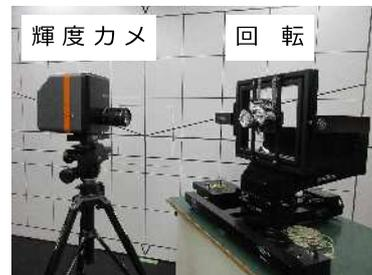
写真 ニアフィールド配光測定装置
