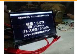
上：荷重表示装置 下：ハンマーによる 衝撃負荷実験
