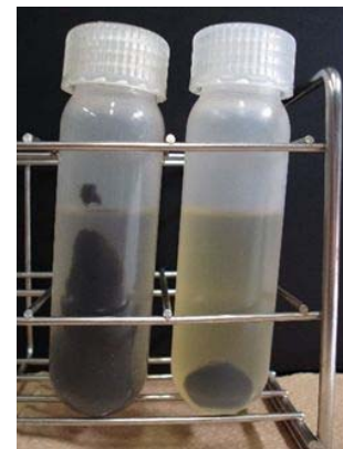
写真2 試作装置による 余剰汚泥の減容化 (左：処理前・右：処理後)
