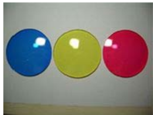
写真 中屈折率レンズの染色結果
