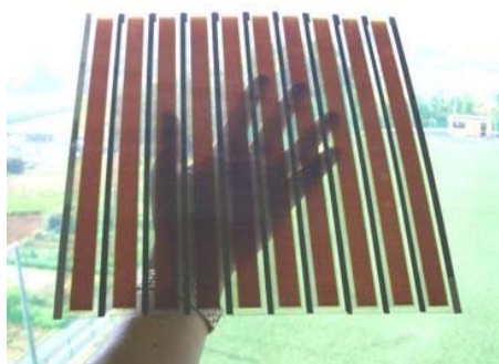
色素増感太陽電池の例 (ペクセル・テクノロジーズ(株)社HPより)
