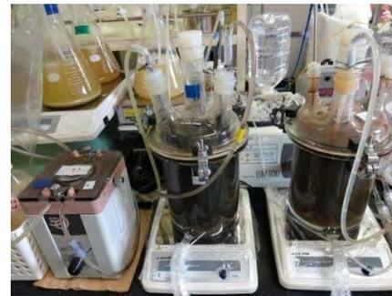
写真1 実験用小型メタン発酵装置
