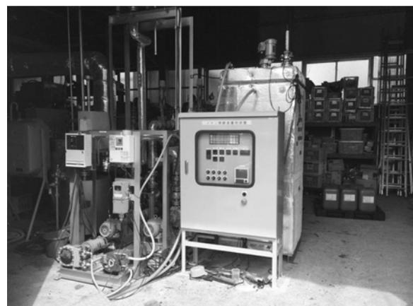
写真 メタン発酵装置（試作機）
