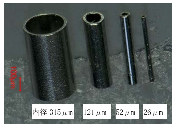
図2 プラチナパイプ (内径 26～315 μm)
