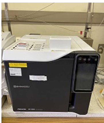
写真 ガスクロマトグラフ ((株)島津製作所 Nexis GC-2030AT)
