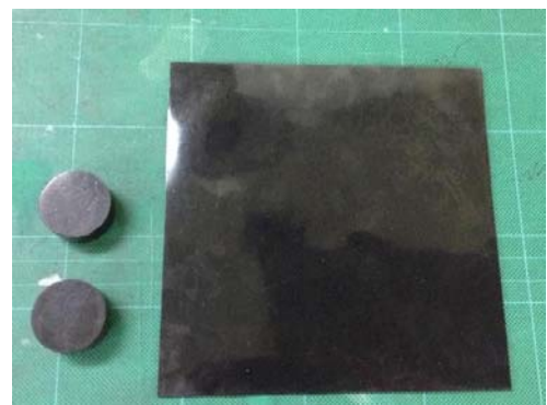
作成した EPDM ゴムサンプル 物性試験用の試験片を切り出す
