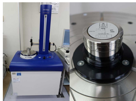
図2 真円度測定機とフリックマスター （フリックマスターに UKAS 校正を実施）
