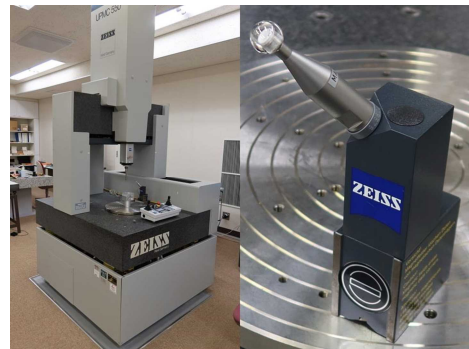
図1 三次元測定機とマスターボール （いずれも JCSS 校正を実施）
