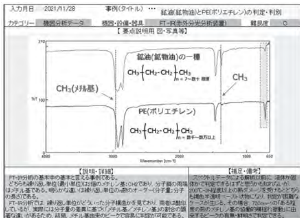
図5 鉱油(鉱物油)とPE(ポリエチレン)の判定・判別
