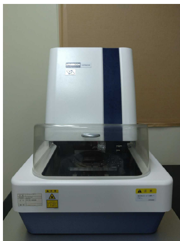
図1 原子間力顕微鏡 ((株)日立ハイテック製 AFM5500M)
