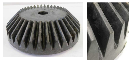
図4 トランスファ成形試作品 （かさ歯車:直径 15cm）
