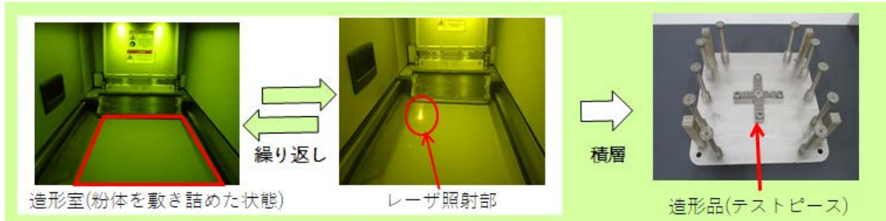
図 パウダーベッド方式による金属3Dプリンタ造形
