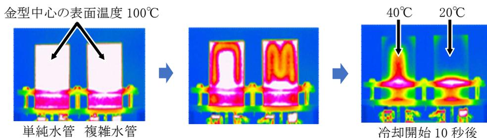
図 「水管形状が金型の冷却に及ぼす影響」デモンストレーションの結果
