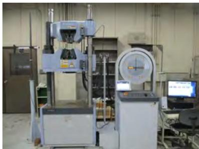
図 1 油圧式万能材料試験機
