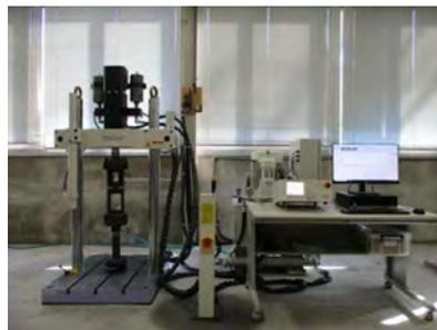
図 2 電気油圧式疲労試験機
