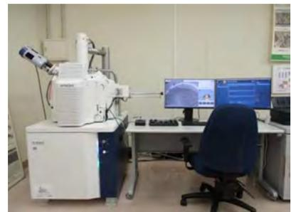
図 3 走査型電子顕微鏡
