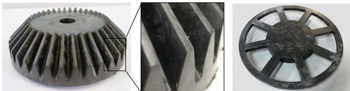
図 6 トランスファ成形による試作製品 (左：かさ歯車、右：モーター用部材)
