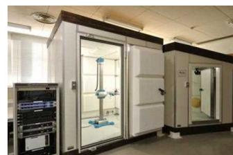
音響透過損失・残響室法吸音率測定システム
