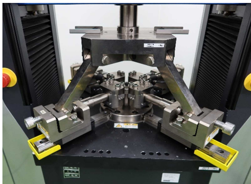
図1 二軸引張試験
