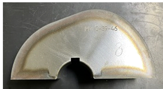
写真2 ロボットにより焼入れしたカム部品
