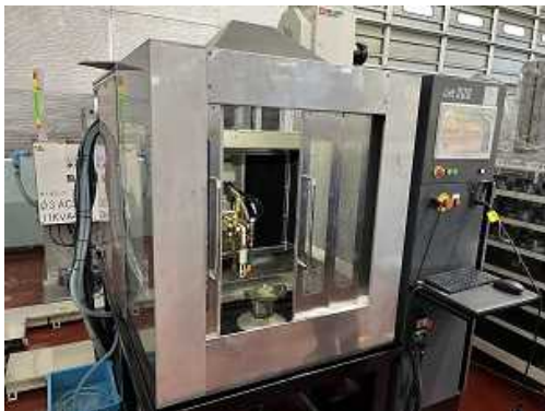
写真1 試作した高周波焼入口ボット
