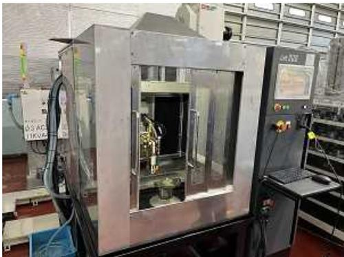
写真1 試作した高周波焼入口ボット
