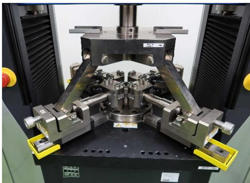
図1 二軸引張試験
