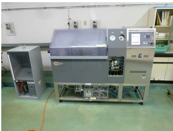
写真 複合サイクル腐食試験機
