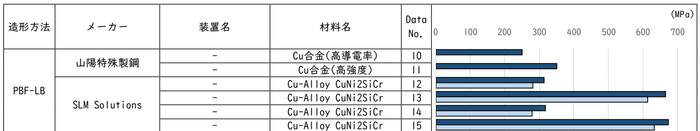
図 3.7.2 銅系 引張強さ (引張試験片の採取方向記載あり) ■ 水平方向 ■ 垂直方向
