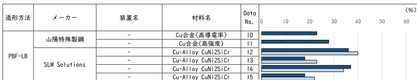
図 3.7.6 銅系 伸び (引張試験片の採取方向記載あり) ■ 水平方向 ■ 垂直方向
