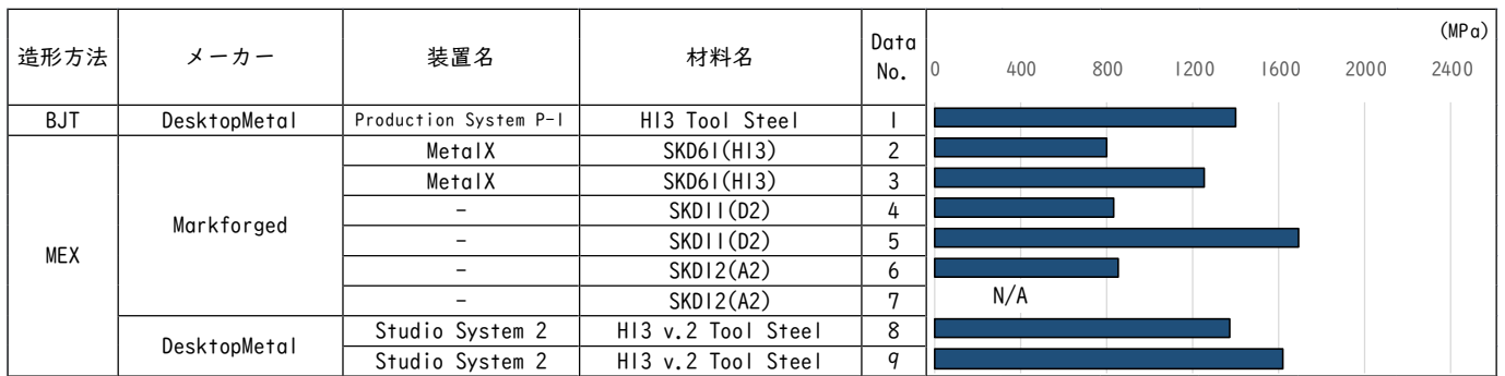
図 3.5.3 合金工具鋼 耐力または降伏応力 (引張試験片の採取方向記載なし)
