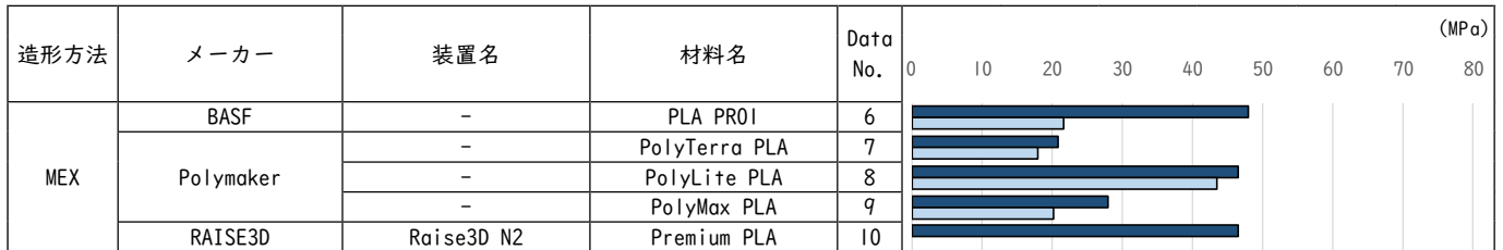
図 2.5.2 PLA 系樹脂 引張強さ (引張試験片の採取方向記載あり) ■ 水平方向 ■ 垂直方向
