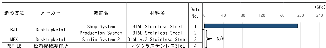
図 3.1.7 SUS316・SUS316L ヤング率 (引張試験片の採取方向記載なし)
