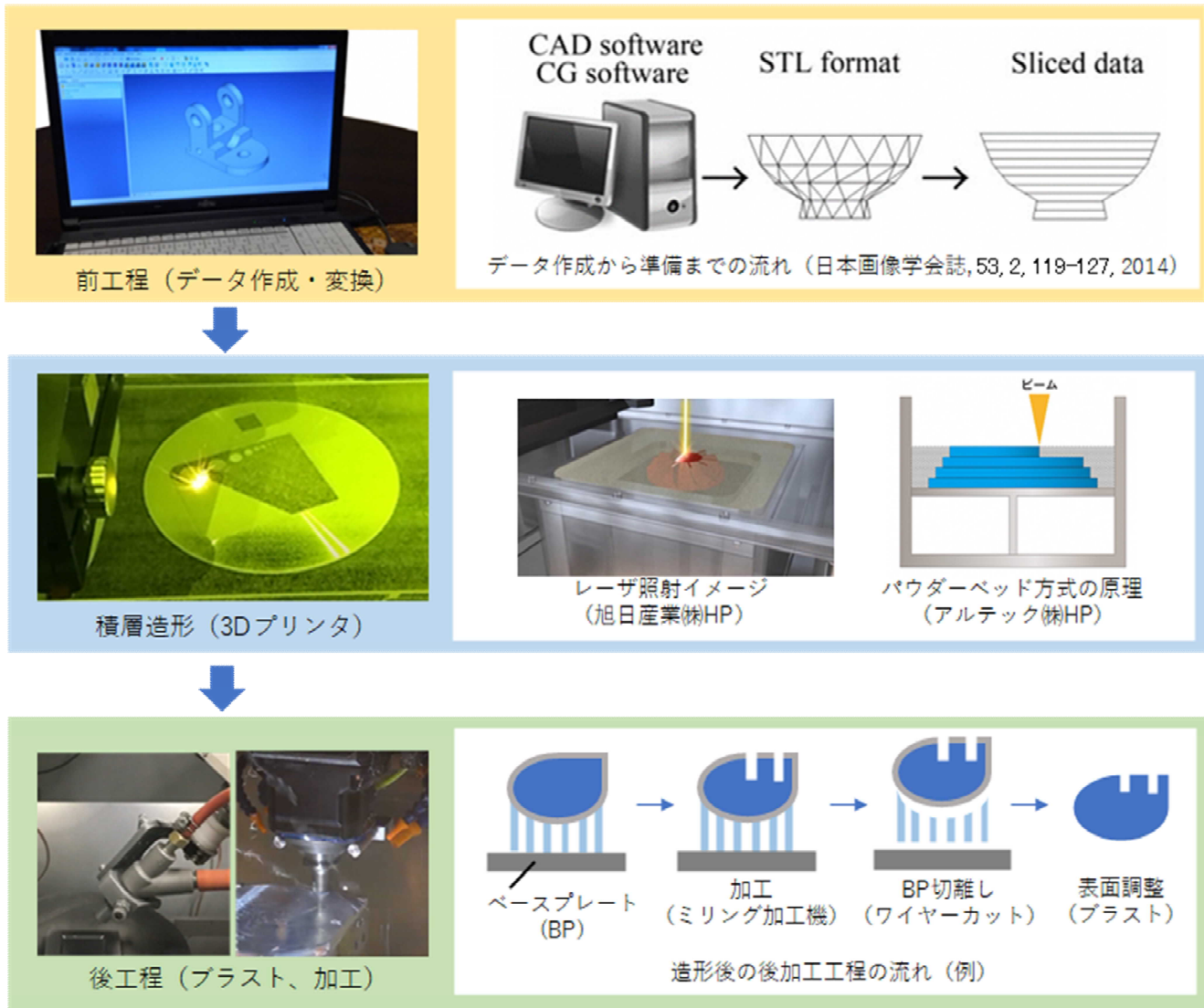
図 7.1 PBF 方式による金属 3D プリンタの工程例
