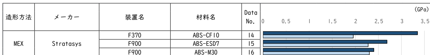
図 2.2.6 ABS系樹脂 引張弾性率（引張試験片の採取方向記載あり） ■ 水平方向 ■ 垂直方向
