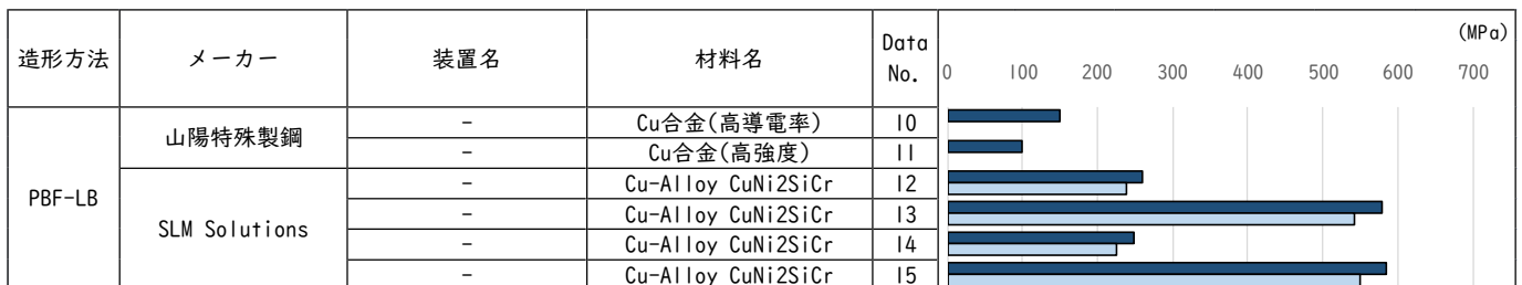
図 3.7.4 銅系 耐力または降伏応力 (引張試験片の採取方向記載あり) ■ 水平方向 ■ 垂直方向
