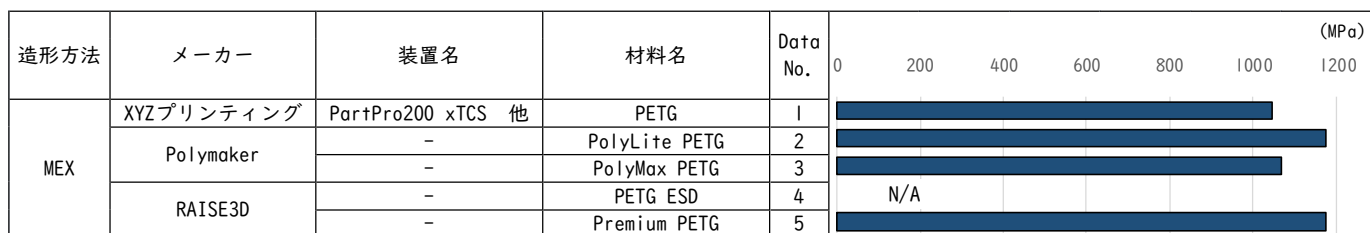
図 2.6.8 PETG 系樹脂 曲げ弾性率
