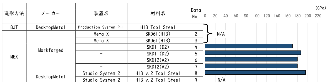
図 3.5.7 合金工具鋼 ヤング率 (引張試験片の採取方向記載なし)
