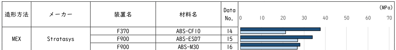
図 2.2.2 ABS系樹脂 引張強さ (引張試験片の採取方向記載あり) ■ 水平方向 ■ 垂直方向
