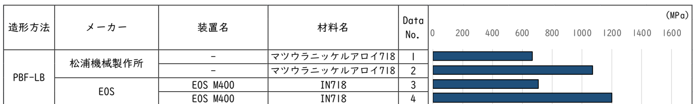
図 3.14.3 インコネル 718 耐力または降伏応力 (引張試験片の採取方向記載なし)
