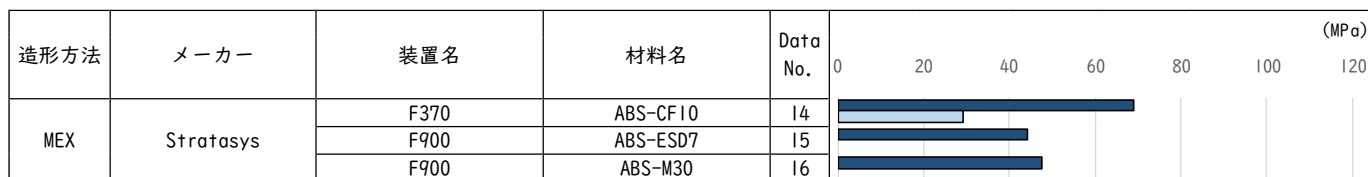
図 2.2.8 ABS系樹脂 曲げ強さ（引張試験片の採取方向記載あり） ■ 水平方向 ■ 垂直方向
