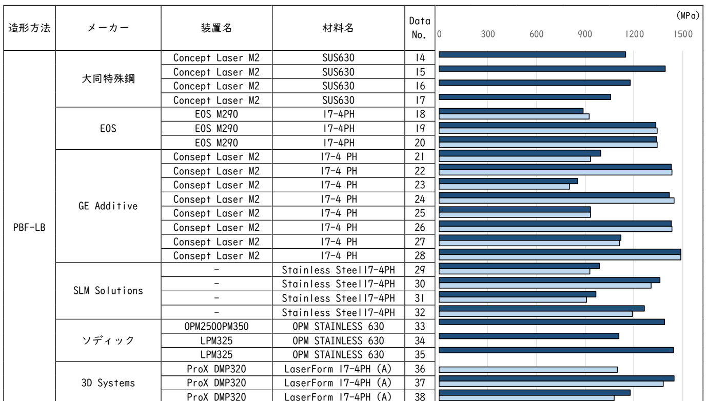
図 3.2.2 SUS630・17-4PH 引張強さ（引張試験片の採取方向記載あり）■ 水平方向 ■ 垂直方向
