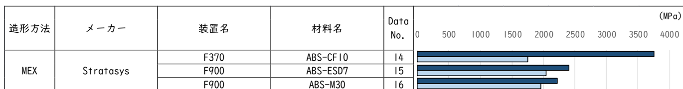
図 2.2.10 ABS 系樹脂 曲げ弾性率（引張試験片の採取方向記載あり） ■ 水平方向 ■ 垂直方向
