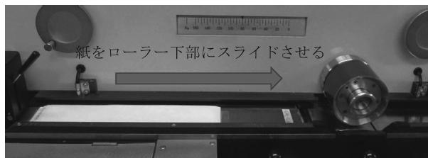
写真 2 万能印刷適性試験機を用いた表面強さの評価
