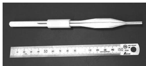
図6 把持力微調整可能ピンセットの外観
