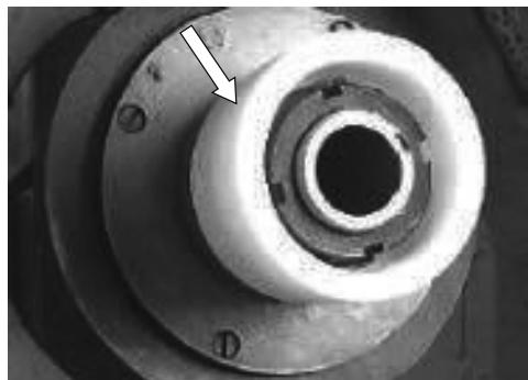
図3 クラッチケース（矢印指示部）の外観
