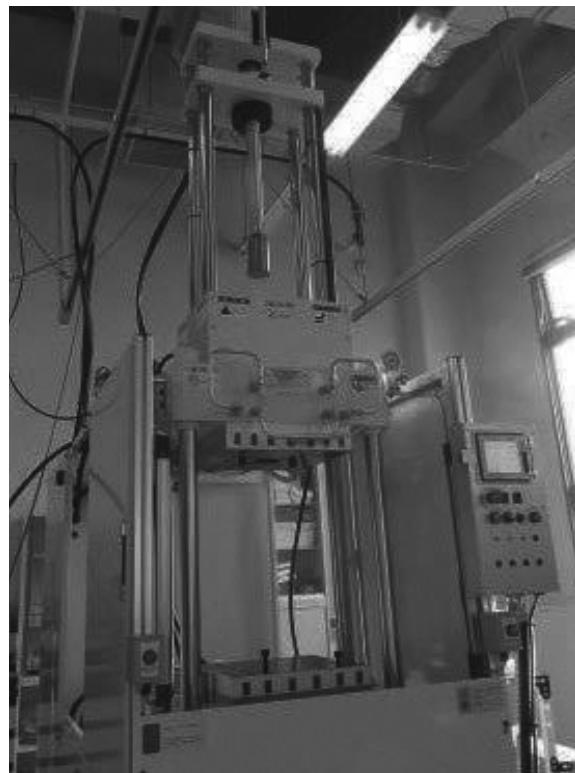
図11 熱可塑性CFRP用トランスファ成形機
