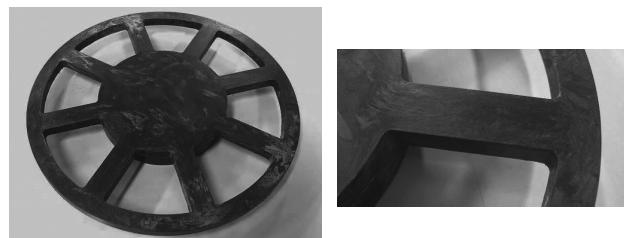
図15 モーター用構造部材 (直径165mm)
