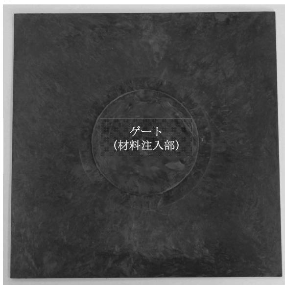
図3 成形した200mm角、厚さ2mmの平板
