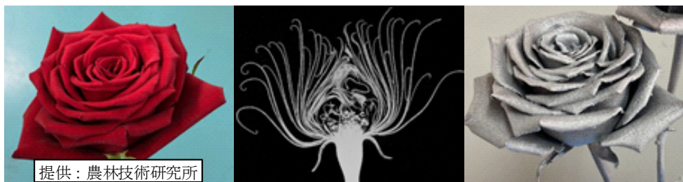
図2 バラの造形（左：実物、中：断面図（X線CT撮影）、右：造形物）
