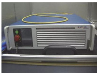
▲波長2 \mu\text{m} 帯ファイバーレーザー 波長：2 \mu\text{m} 最大出力：120W 走査方法：XYステージ、ガルバノスキャナー 主な用途：透明樹脂の溶着
