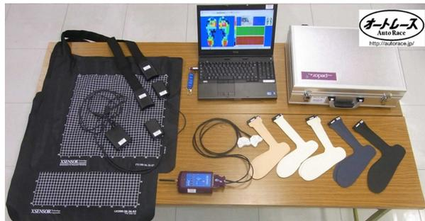
図1 圧力分布測定装置一式
