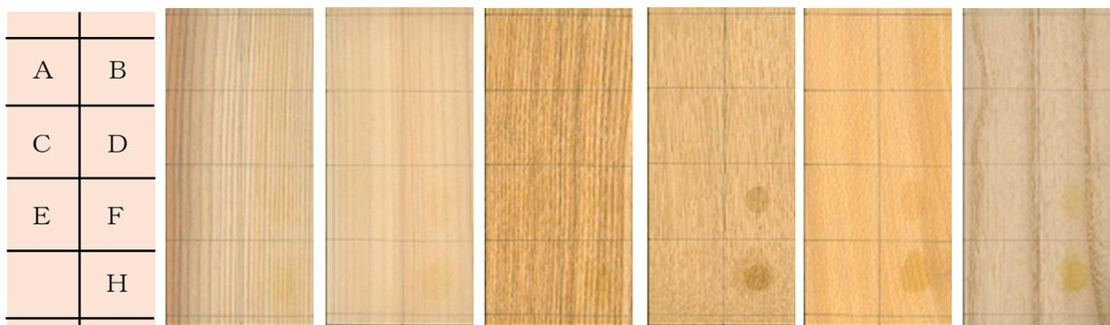
図4 変色再現実験結果（アルカリ性溶液（水酸化カルシウム水溶液））
