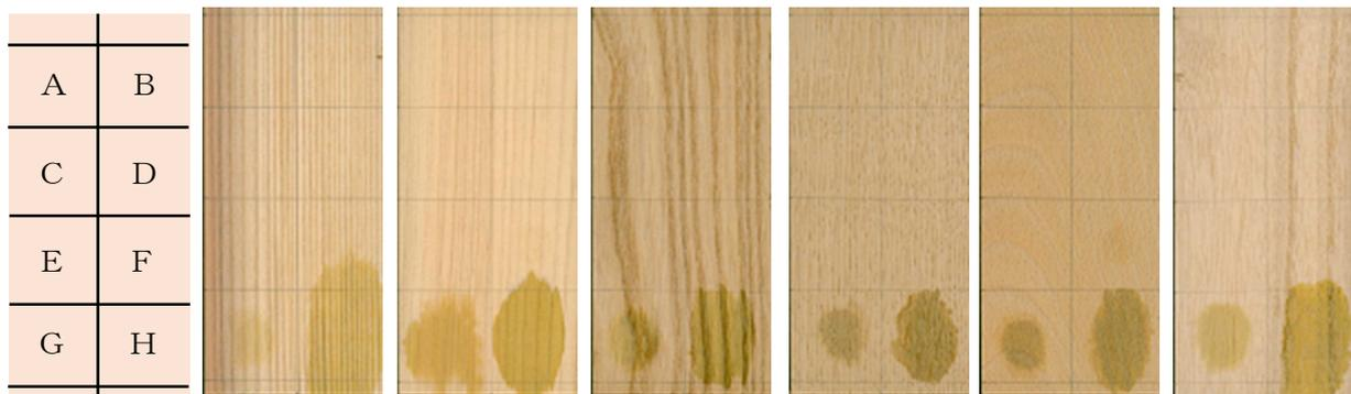
図3 変色再現実験結果（アルカリ性溶液（水酸化ナトリウム水溶液））
