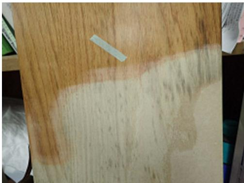
写真8 鉄汚染が疑われる試料（研磨済）
