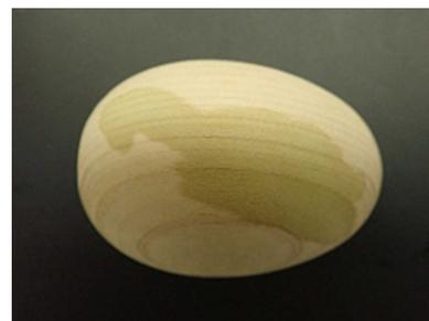
写真7 ヒノキ製玉子状試料の変色再現試料
