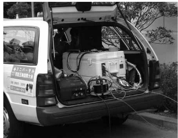
写真2 車載用におい計測システム
