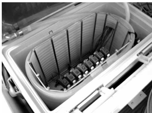
写真3 車載用恒温箱(内箱)内のセンサ保持具
