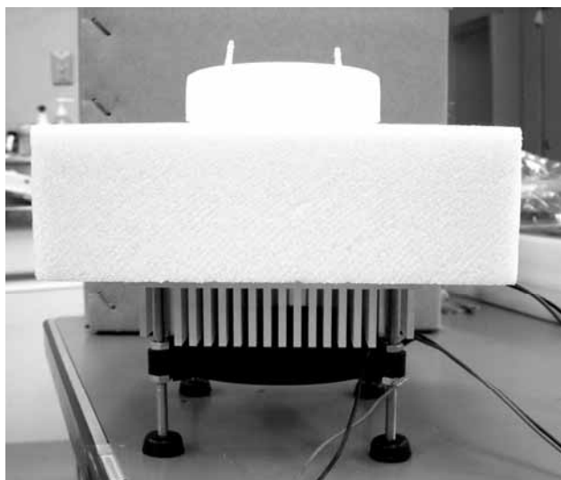
写真5 温度可変型におい計測装置
