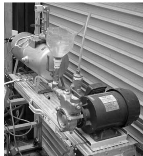
図1：余剰汚泥可溶化装置（試作機）
