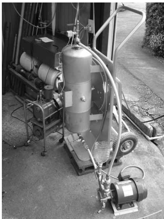
図4 密閉循環型汚泥可溶化装置 (改良機)
