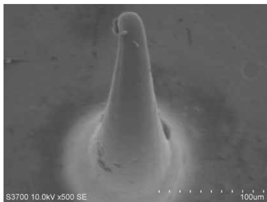
図.1 Ni電鍍針 長さ500µm SEM観察像
