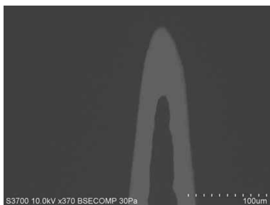
図.2 Ni電鍍針断面 SEM観察像
