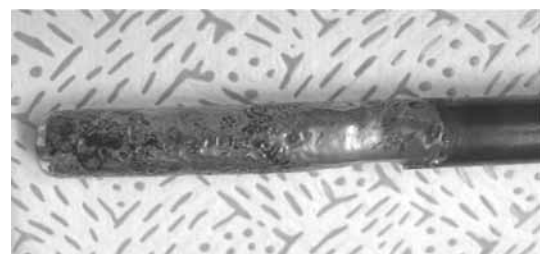
図4 2h試験後の窒化処理品浸漬部
