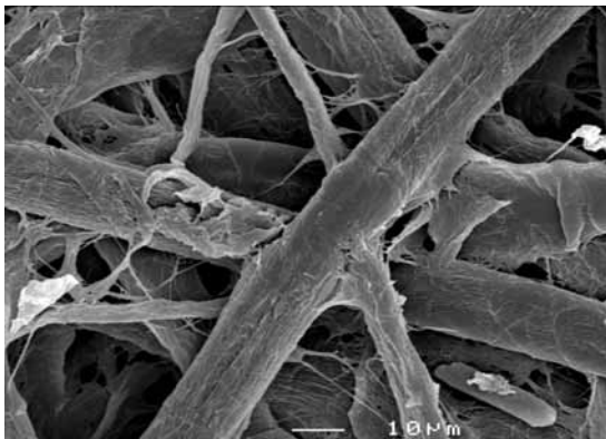
写真2 リサイクル5回目のパルプ繊維表面のSEM像
