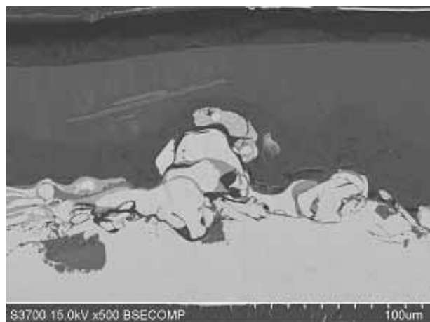
図2 現行品断面SEM観察 (下層の白いのが金属、上層がフッ素樹脂)
